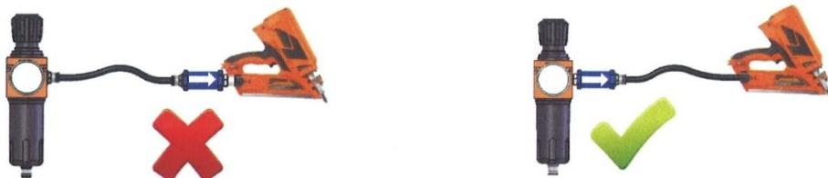
Der HoseGuard muss am Ende einer starren Leitung montiert werden!
