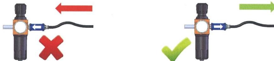
Der Innen-Durchmesser am Eingang, muss mindestens dessen des Ausgang-Durchmessers entsprechen!
